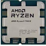
Le processeur aussi a plusieurs noms, on parle de microprocesseur ou de CPU, de l'anglais **Central Processing Unit**. Son rôle est le traitement de l'information numérique et il ne communique qu'en chiffres binaires ou Bits, un langage composé d'une suite de 0 et de 1. Il fait ainsi les calculs nécessaires à l'exécution des programmes et instructions à une vitesse en partie déterminée par sa fréquence exprimée en Hertz ou plutôt, dans le cas des processeurs actuels, en GigaHertz (GHz).
